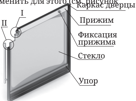
Рисунок 12. Ремонт светопрозрачного экрана дверцы модели «Витра»
