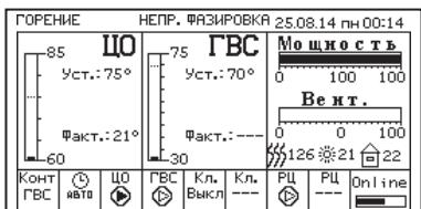
Насосы отображаются пиктограммой с температурой соответствующего контура возле изображения насоса. Работающий насос отображается зеленой пиктограммой, при остановленном насосе пиктограмма красная. Серая пиктограмма насоса обозначает, что насос не используется. Если датчик соответствующего контура не подключен, то вместо температуры отображается «---».
