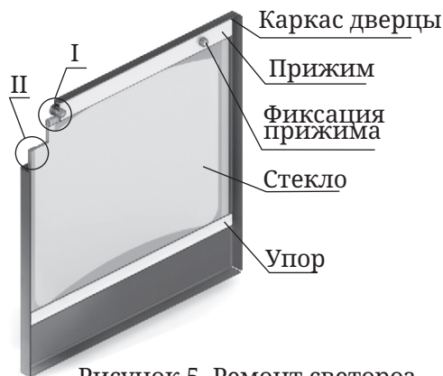
Рисунок 5. Ремонт светопрозрачного экрана дверцы
